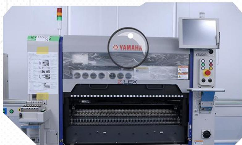
**YAMAHA** Высокоскоростная укладочная машина
